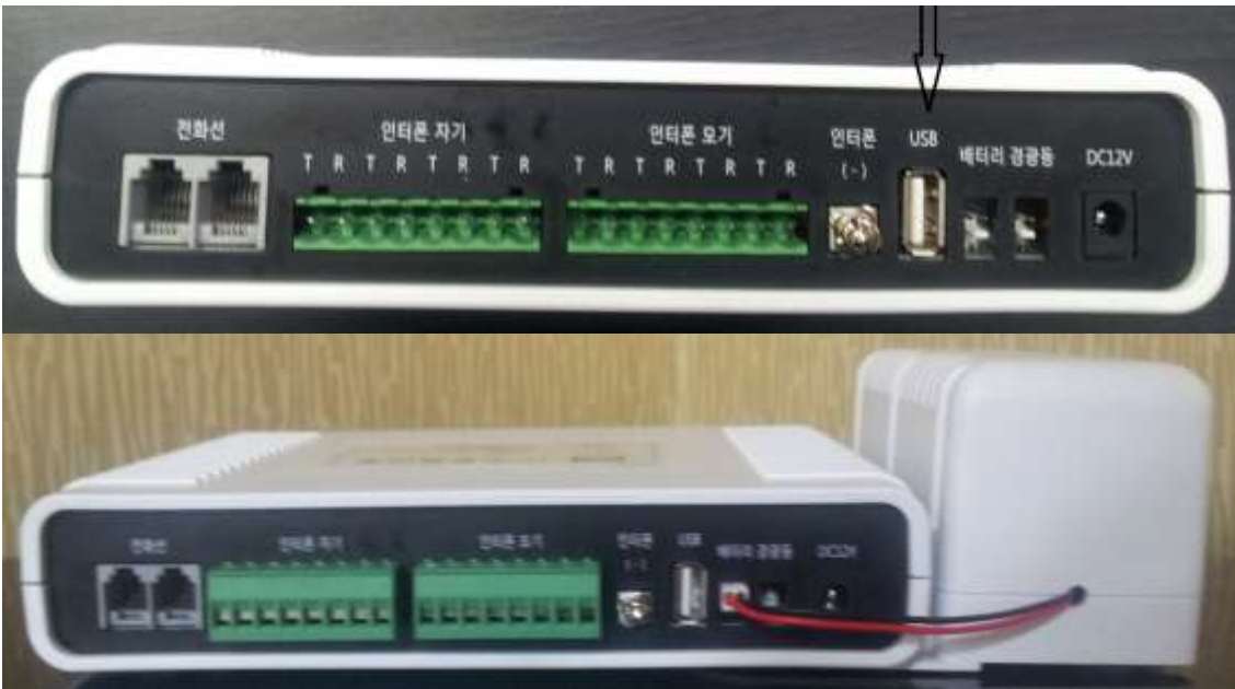
KS1204 후면 사진(USD 콘솔포트가 있고 보조배터리 직접 장착)
