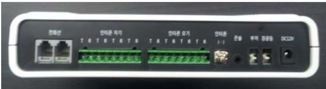
KS1104 후면 사진(RS232 콘솔포트, 배터리 별도장착 어댑터 사용)
